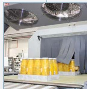
**1** À l'entrée de la machine, un démêleur basculant motorisé canalise correctement les récipients en vrac transportés par un convoyeur avec chaînes en matière thermoplastique à faible coefficient de friction. Dans la zone de formation du paquet, les récipients sont regroupés dans le format désiré au moyen d'un dispositif pneumatique qui fonctionne en mode alterné (LCM 30) ou électronique (LCM 40 EL)
