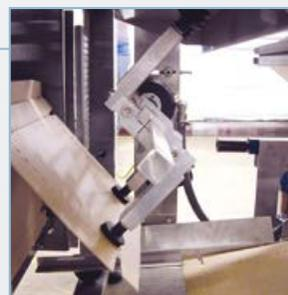
**1** Un système avec une entrée à une file facilite l'insertion correcte des récipients en vrac sur un convoyeur. Le système d'entrée du produit est caractérisé par un mouvement continu et la formation du paquet est effectué par un système de séparation du produit à double bande contrôlé par axe électronique. Ensuite, les produits en vrac sont déplacés par le convoyeur d'entrée au convoyeur de conditionnement grâce à un système rotatif.
