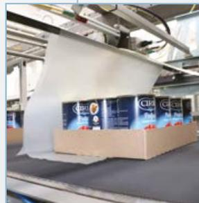
**1** Un système avec une entrée à une file facilite l'insertion correcte des récipients en vrac sur un convoyeur. Le système d'entrée du produit est caractérisé par un mouvement continu et la formation du paquet est effectué par un système de séparation du produit à double bande contrôlé par axe électronique.
