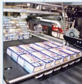
1 À l'entrée de la machine, un démêleur basculant canalise correctement les récipients en vrac transportés par un convoyeur avec chaînes en matière thermoplastique à faible coefficient de friction. Dans la zone de formation du paquet, les récipients sont regroupés dans le format désiré au moyen d'un dispositif pneumatique qui fonctionne en mode alternatif.
