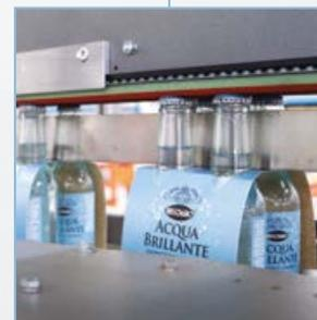
**1** Sur le convoyeur d'entrée de la machine, équipé de chaînes en matériel thermoplastique à faible coefficient de frottement, les récipients en vrac arrivent déjà canalisés sur 1 ou 2 files.
