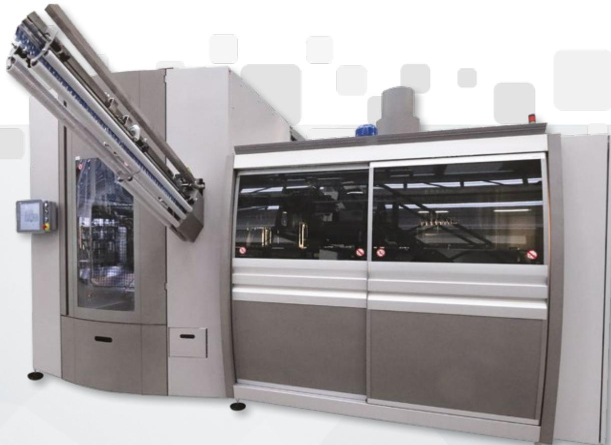
El proyecto EBS E ERGON prevé procesos totalmente electrónicos que permiten la eliminación de todos los movimientos mecánicos y de las levas relativas y que, de hecho, hacen la sopladora una máquina "cam-less" (sin levas).
