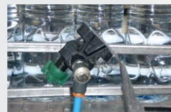
Smiline输送带配有全自动喷嘴润滑系统，能够降低噪音水平、运行成本和清洁工作量。根据客户的需要，可以提供“无油”或“无水”方式。
